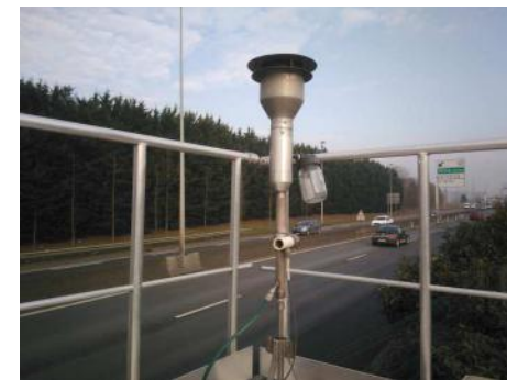
Tête de prélèvement pour l'analyse des particules (PM10) sur le station de mesures temporaire en bordure de la Sud III (Petit-Quevilly).
