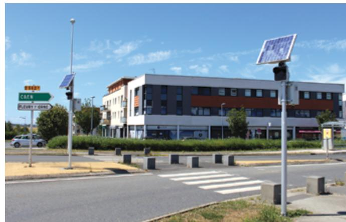
Deux feux clignotants solaires ont été installés à l'entrée de la Ville (côté périphérique). Ces feux se déclenchent à l'approche d'un véhicule afin d'alerter le conducteur de la présence d'un passage protégé. Les piétons sont, en effet, de plus en plus nombreux à traverser pour accéder à l'arrêt de bus et aux entreprises de la zone d'activités.
